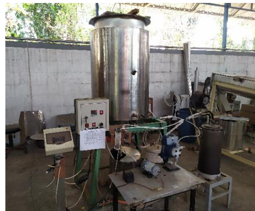
Gambar 3. Unit Operasi yang terdiri dari kolom evaporator sederhana
