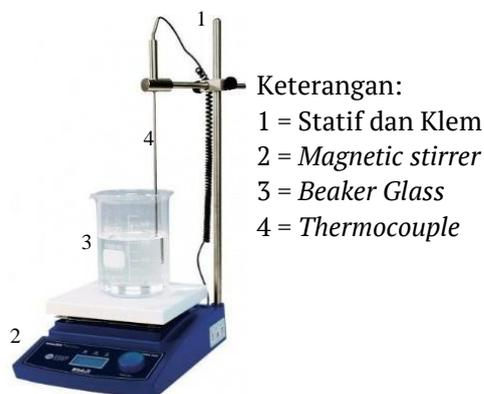
Gambar 1. Rangkaian Alat Sintesis Nano-PCC
